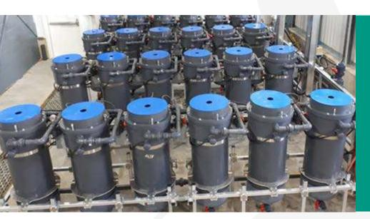
24 réacteurs ECOTHOR®-16R configurés pour opérer en mode électrocoagulation avec anode ANO2M (alliage Mg) avec PLC Allen-Bradley (client spec)
